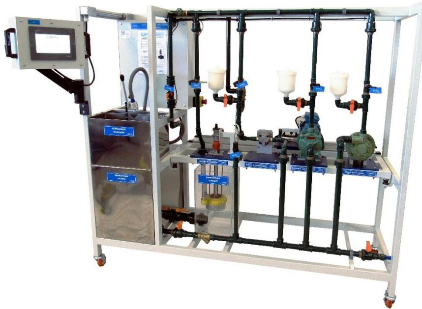
A bancada XL27 é uma unidade autônoma projetada para realizar experimentos em bombas hidráulicas visando levantar e comparar curvas de diversos modelos de bombas.
